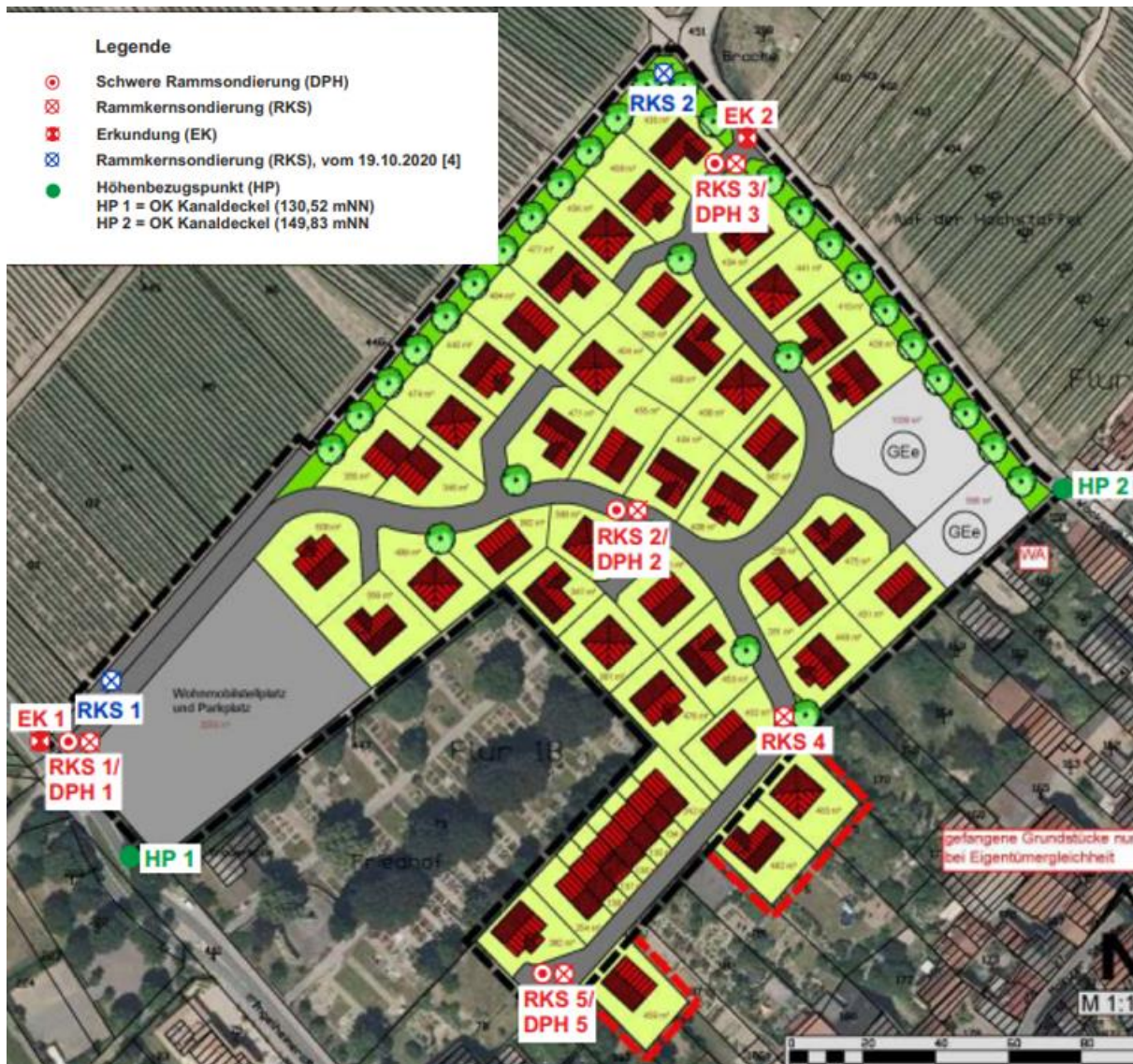
Abbildung 15: Die Sondierpunkte des Bodengutachtens von baucontrol im Plangebiet
