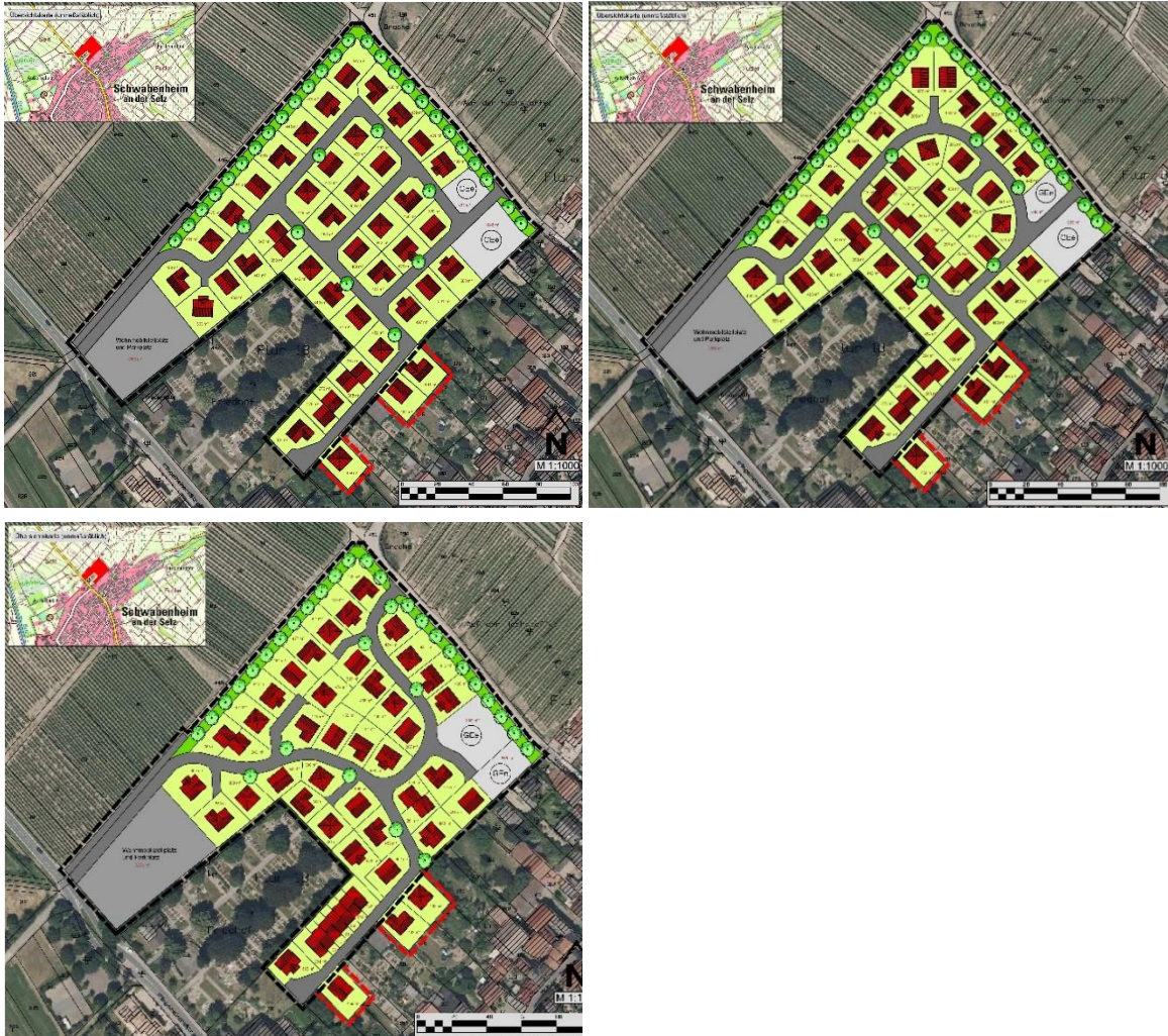
Abbildung 28: Erschließungsvarianten und Bebauung nach DÖRHÖFER & PARTNER
