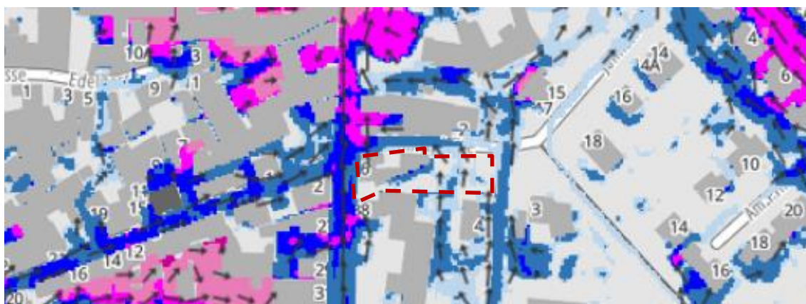
Sturzflutkarte des Landesamts für Umwelt Rheinland-Pfalz, Darstellung des Geltungsbereichs auf der Karte „Extremer Starkregen (SRI10, 4 Stunden)“
